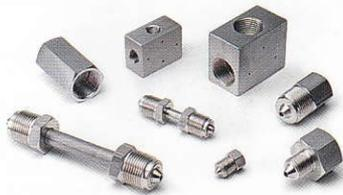
Un diseño de adaptador / tubo roscado con cono 58/60 grados. Un estándar industrial cuando se trabaja a presiones por encima de 20.000 psi. Presión - 150.000 psi máximo.
