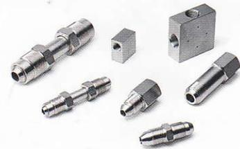
Un diseño de adaptador / tubo roscado con cono 58/60 grados. El amplio orificio permite un caudal máximo de líquidos y gases. Presión - 20.000 psi.
